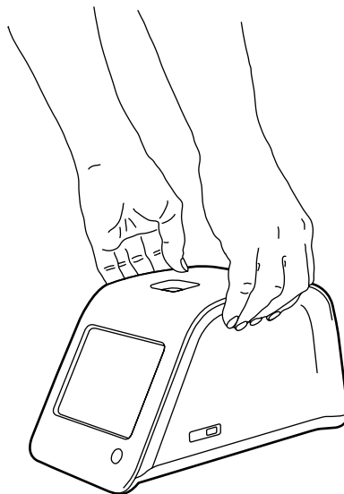
Figura 5 Sollevamento dello strumento con due mani.
