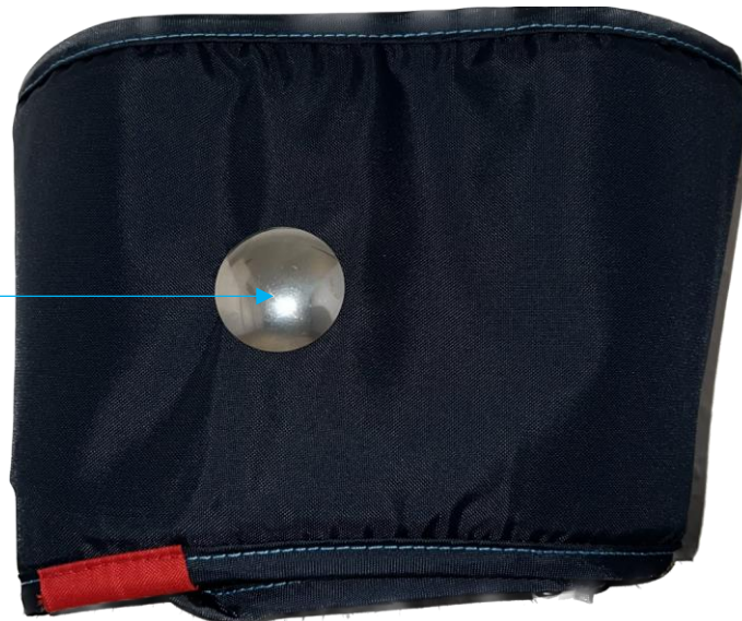
Bild 2-3: Integrierte EKG-Elektrode in der Manschette
